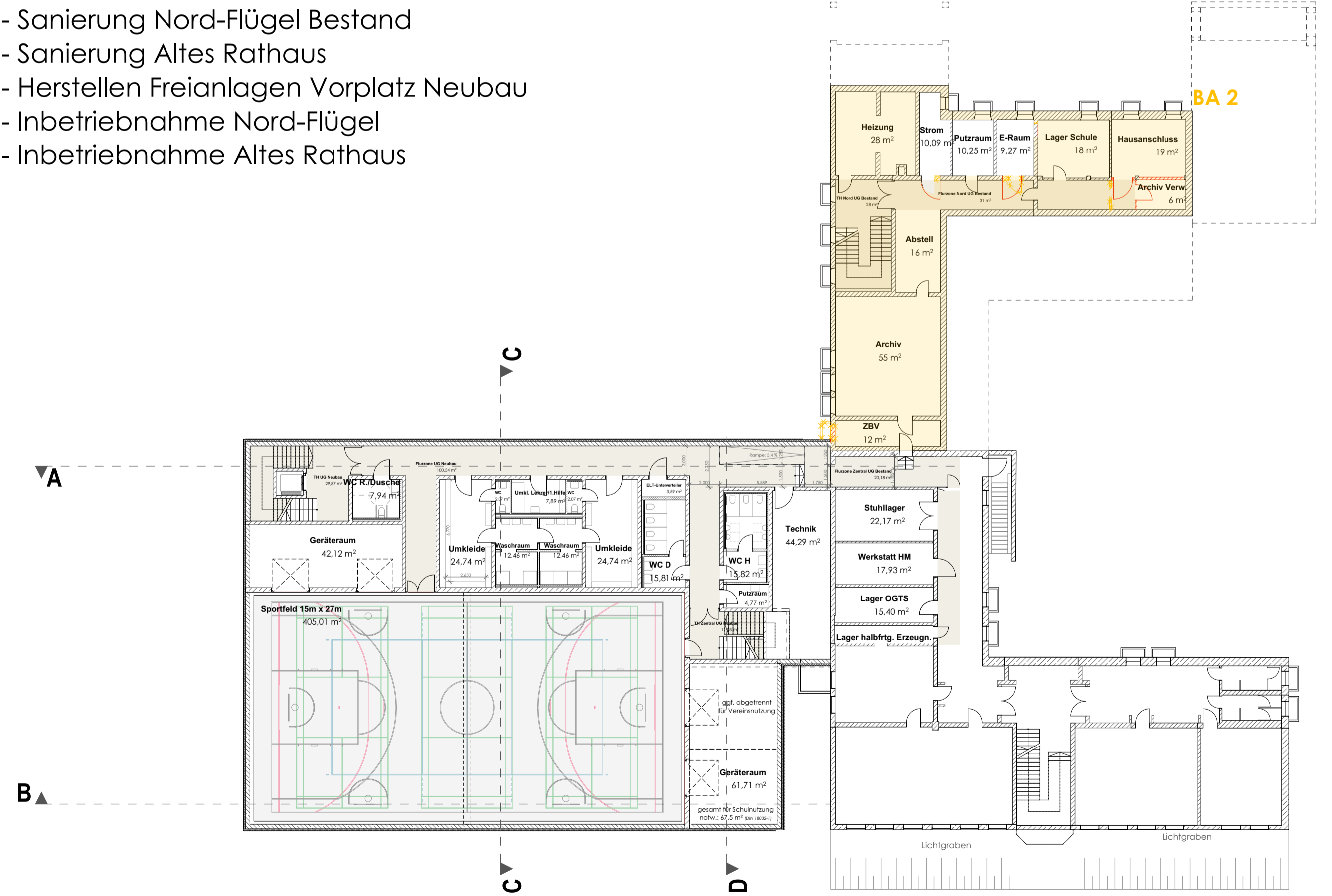
Grundriss Untergeschoss, Bauabschnitts-Planung, BA2, M 1/250
