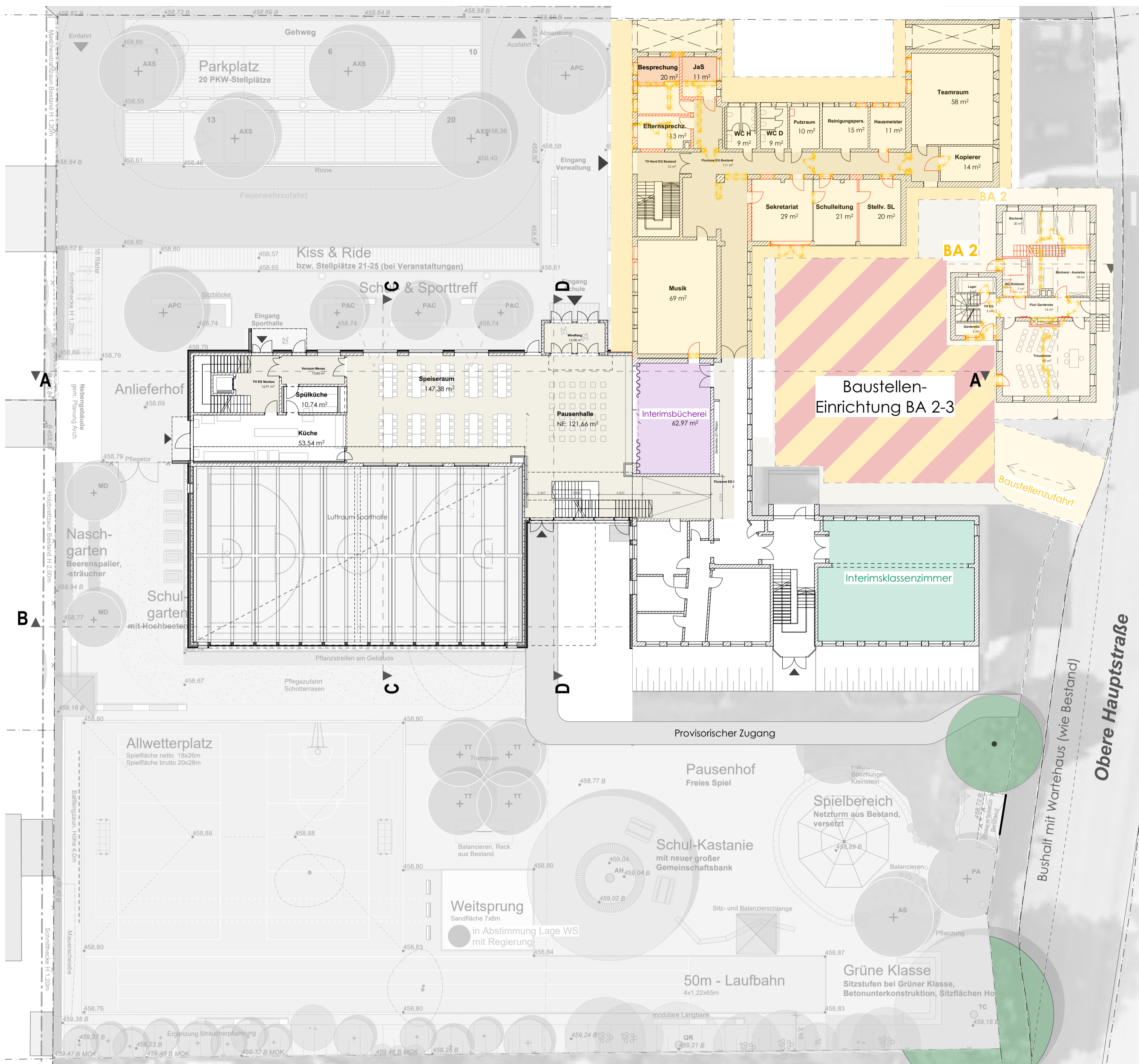
Grundriss Erdgeschoss, Bauabschnitts-Planung, BA2, M 1/250
