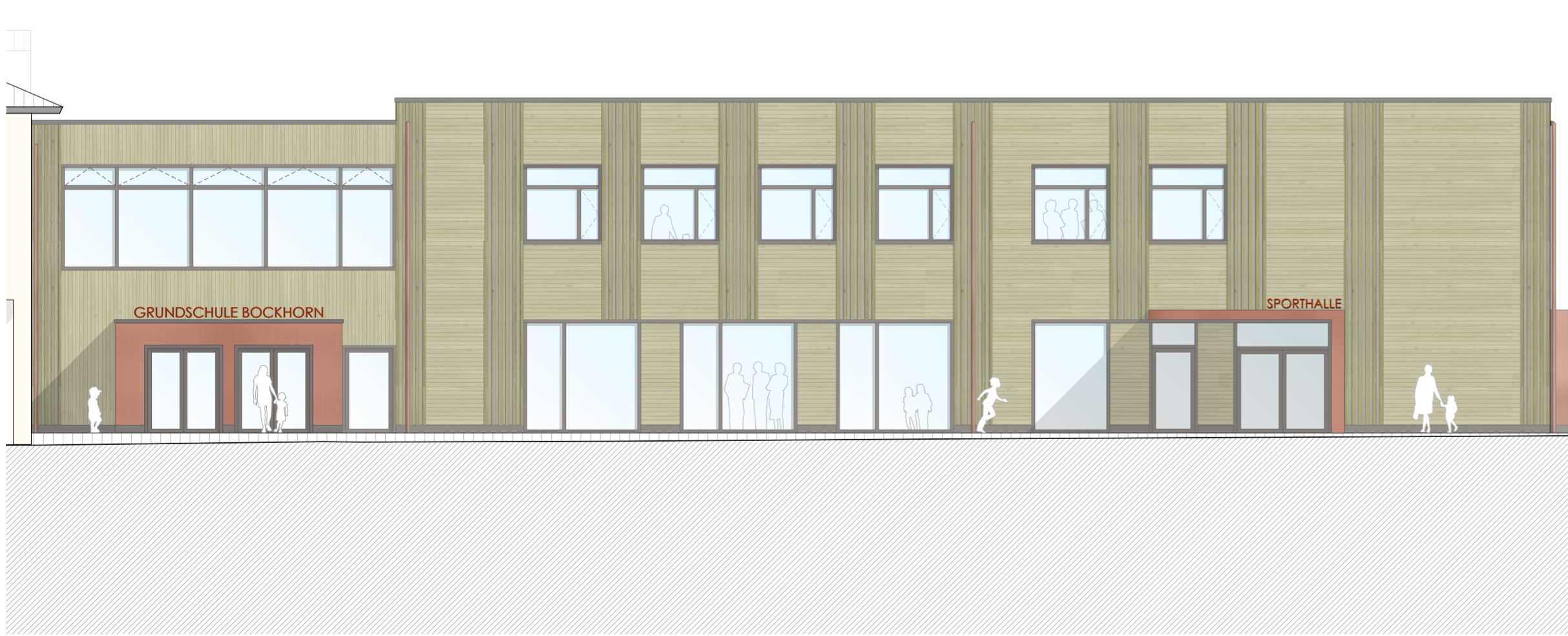
Ansicht Nord Neubau, Variante 1, M 1/125
