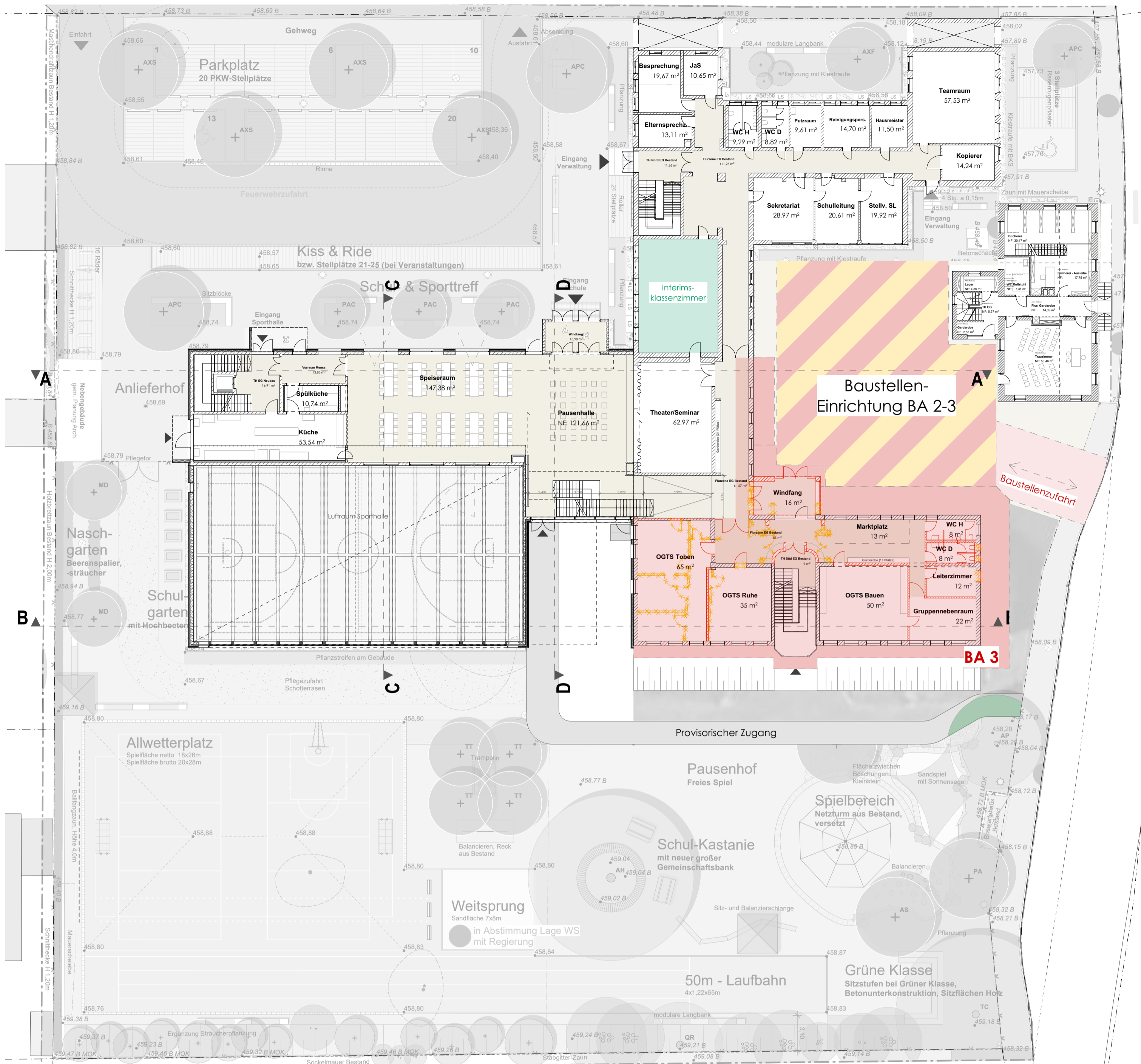
Grundriss Erdgeschoss, Bauabschnitts-Planung, BA3, M 1/250
