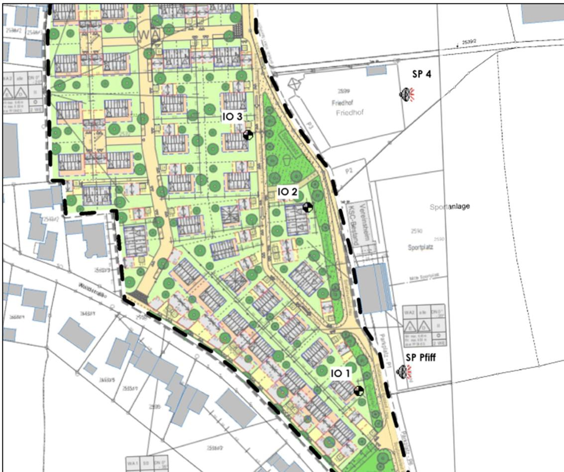
Abbildung 7: Übersicht mit Darstellung der Punktschallquellen der Spitzenpegel (SP Pfiff und SP 4)
